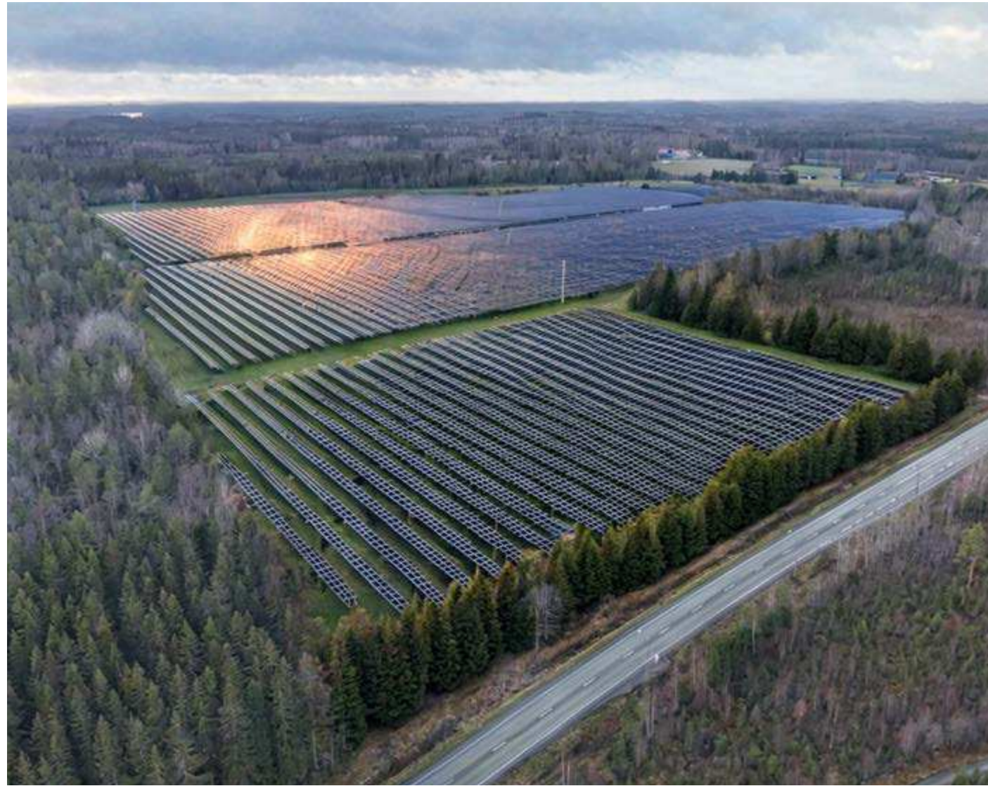
Kuva 30. Havainnollistava kuva kasvillisuudesta. Kuvassa on esitetty Lahdentien eteläpuolinen aurinkovoimalan alue ja visualisoitu tien reunavyöhykkeen käsittelyä. Tien reunaan voidaan istuttaa suurikokoisia kuusentaimia tai jopa valmis kuusiaita, jolloin kasvillisuus tarjoaa välittömästi peittävän näkösuojan paneelialueelle. Toinen vaihtoehto on istuttaa monikerroksellisempaa pensastoa ja puustoa ja avata paikoitellen näkymiä aurinkopuiston alueelle. Nykyinen kasvillisuuden reunavyöhyke suositellaan säilytettäväksi, kun se on mahdollista. Aurinkopaneelit eivät perustu suunnitelmaan, vaan ovat mukana havainnollistamassa kuvaa (mm. niiden suuntaus ei ole totuudenmukainen). (Kuva: Drooni-kuva Sitema Oy, reunakasvillisuus ja paneelit on lisätty Regraft -ohjelman avulla, 2024)
